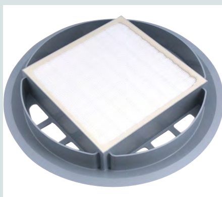
HEPA 13 filteret tilbageholder 99,997% partikler helt ned til 0,3 microner.
